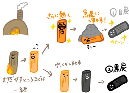
先ず木炭の製造方法についてと、どうして木炭は着火しやすく熱量が多いのかをご説明します。木炭には「白炭」と「黒炭」の二種類があります。「白炭」はウバメガシという比較的硬い木を炭化します。急に熱し、窯出しして灰をかけて急冷します。和歌山の備長炭はこの「白炭」です。それに対して「黒炭」は「ウバメガシ」ほど硬くない「コナラ」の木を使いゆっくり熱くして（炭化）、窯から外へ出してゆっくりと冷却します。
